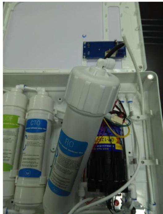
2. Используйте ключ для фильтра, чтобы открутить верхнюю крышку фильтра RO, откручивается против часовой стрелки. Снимите мембрану фильтра обратного осмоса, О-образная часть фильтра должна быть направлена лицом вниз в фильтр и закреплена.
