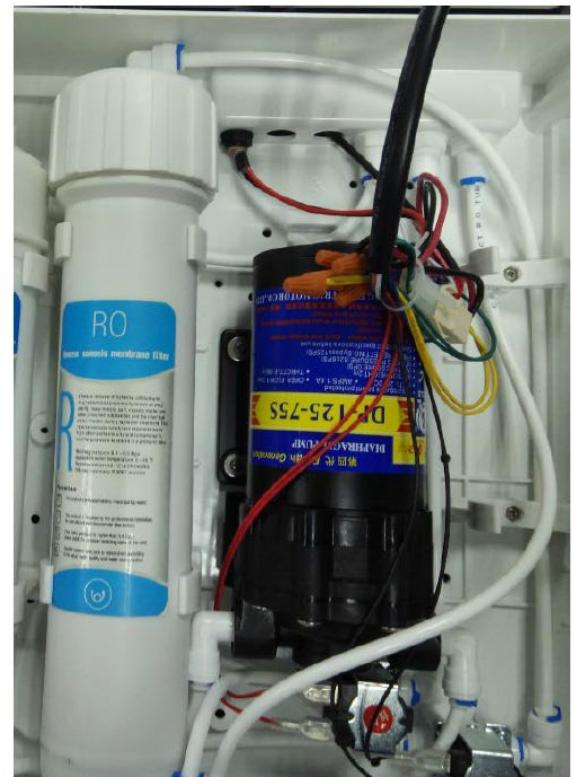
4. Удалите силиконовые заглушки на левой стороне стерилизатора и используйте болты M4X18 болты для крепления рамы системы очистки к стерилизатору.
