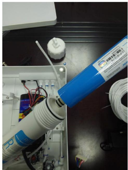
3. Используйте ключ для фильтра, чтобы закрутить и затянуть крышку фильтра по часовой стрелке. Вставьте обратно ПВХ трубку в верхнюю часть фильтра и закрепите хомутом синего цвета. Затем установите фильтр обратно и закройте крышку системы.
