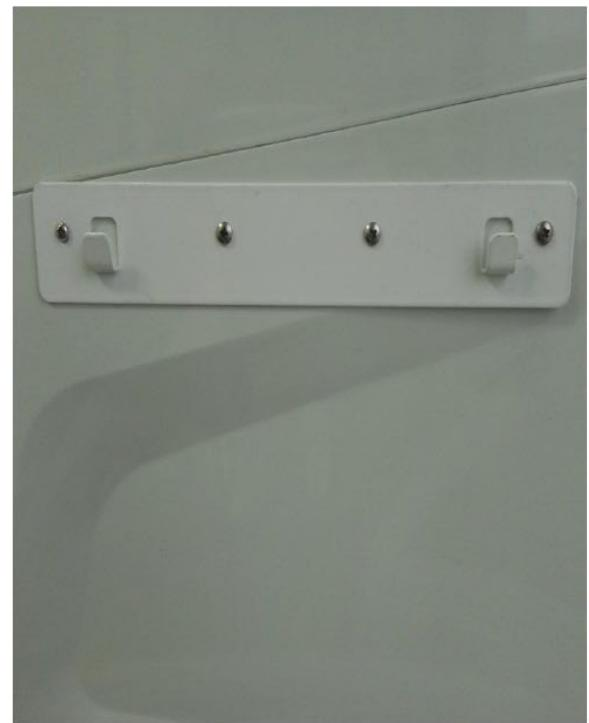
5. Два паза на верхней задней части системы очистки предназначены для крепления к раме. Во время крепления убедитесь, что система очистки стоит горизонтально по направлению вверх.
